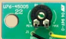
Potenciómetro Interno en el panel de control
